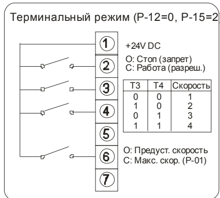
4 предустановленных скорости и макс. скорость
