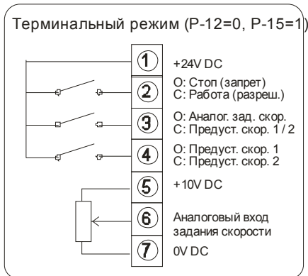
Аналоговое задание скорости с двумя предустановленными скоростями
