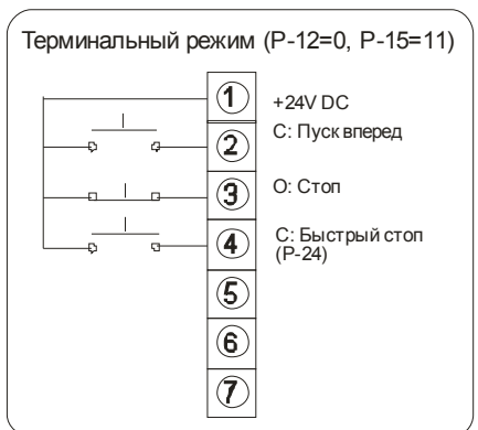
Управление кнопками без фиксации с использованием быстрого останова
