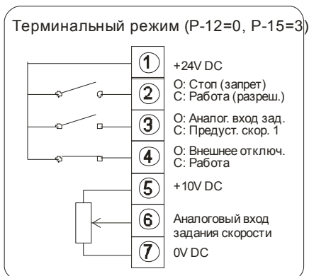
Аналоговое задание скорости с одной предустановленной скоростью и термистором
